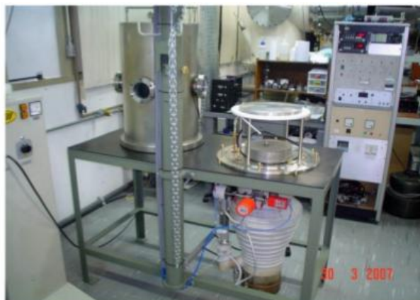
FIGURA 6: Câmara de alto vácuo, de 120 litros, para o sistema de crescimento de DLC usando a técnica DC Pulsada PECVD.
